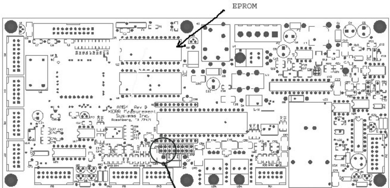
J1 = DEPTH, JUMPER OFF=FEET, ON=METERS
